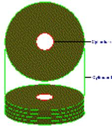
Au départ, la structure des disques dur est analogue à celle des disquettes. Dans le cas des disques durs, il s'agit de pistes, en fait des cercles concentriques. Ces pistes sont réparties de manière homogène sur tous les plateaux du disque. Une même piste s'étend sur l'ensemble des plateaux. Vous pouvez aussi vous représenter cette division sous la forme de corps cylindriques emboîtés, constitués par les pistes situées l'une au-dessus de l'autre dans la
